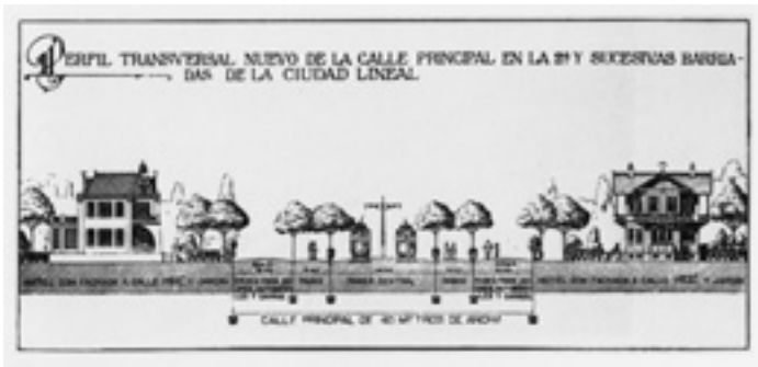
Dwarsdoorsnede van de hoofdstraat van het project van de Ciudad Lineal van Arturo Soria y Mata (1886) (breedte 40 m.) en van de Grand Boulevard door Arthur Stocklet (breedte 50 m.).
