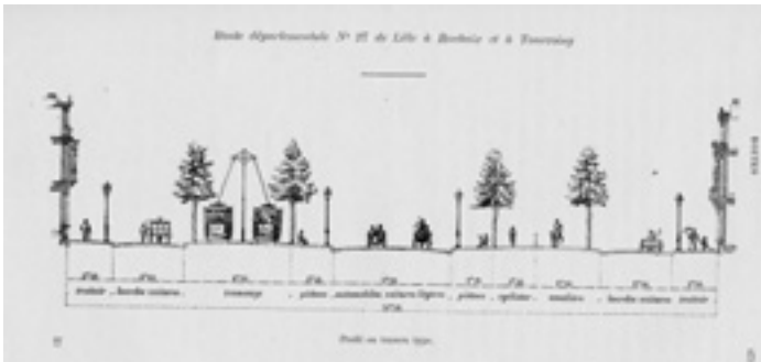
Profil en travers de la rue principale de 40 m de la Cité Linéaire d'Arturo Soria Y Mata (1886) et du Grand Boulevard de 50 m d'Arthur Stocklet (1905)
